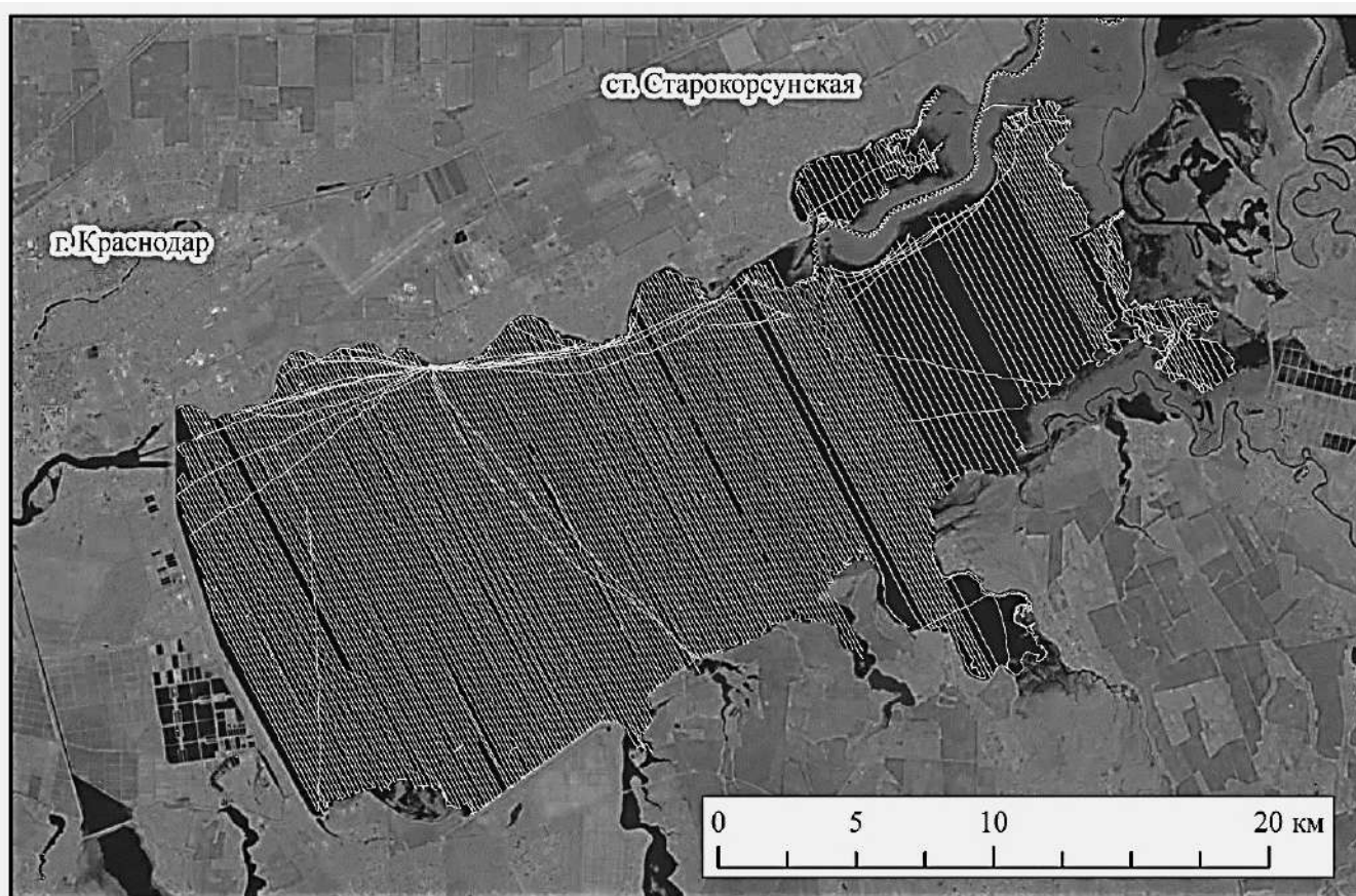
Рис. 1. Схема расположения промерных галсов в Краснодарском водохранилище / Fig. 1. Layout of the survey lines in the Krasnodar reservoir
